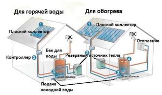
Рисунок - 1. Основная схема разрабатываемого устройства
