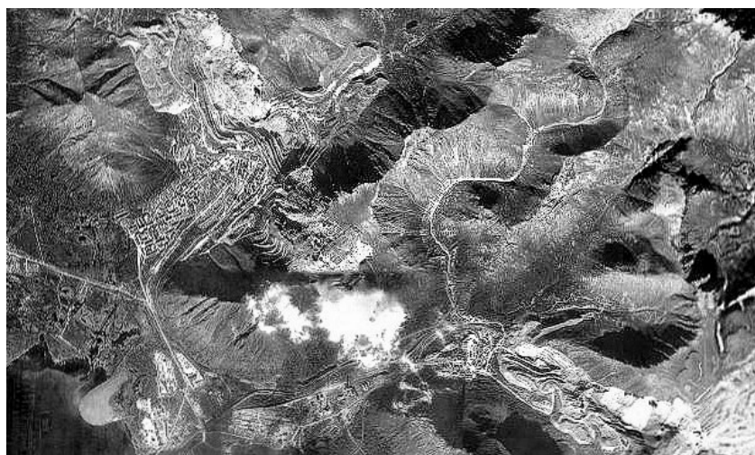
Рис. 1. Ареал комплексной отработки хибинских месторождений. Прерывистый ров обрушения над очистными пространствами трассируется на 7,5 км с СЗ на ЮВ от Рудника им. Кирова (Кукисвумчоррское месторождение) до Расвумчоррского рудника (месторождение Апатитовый цирк) (Мозаика ГУГЛ)
