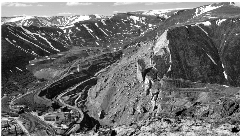
Рис. 2. Ров обрушения на юго-западных склонах горы Апатитовой над отработанным до глубины 520 м от поверхности участком Кукисвумчоррского месторождения. Слева – внешние отвалы в троговой долине ручья Ворткеуай. Вид с юго-востока, с хребта Юкспорр (Фото С. Яровой)
