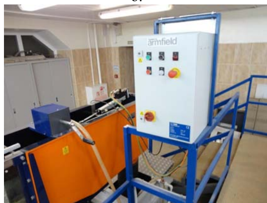
Рис. 3. Основные элементы экспериментальной установки: а – волонопродуктор; б – пульт управления волонопродуктором
