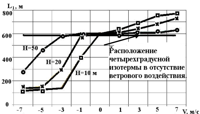
Рис. 5. Месторасположение области схождения вихревых структур в зависимости от скорости ветра и глубины водоема через t=15 мин после начала воздействия ветра на водную поверхность.
