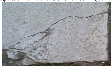
Рис. 8. Характер разрушения от совместного действия момента и поперечных сил.
