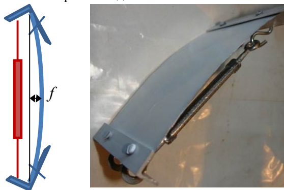
Рис. 9. Схема деформирования прямоугольных образцов
