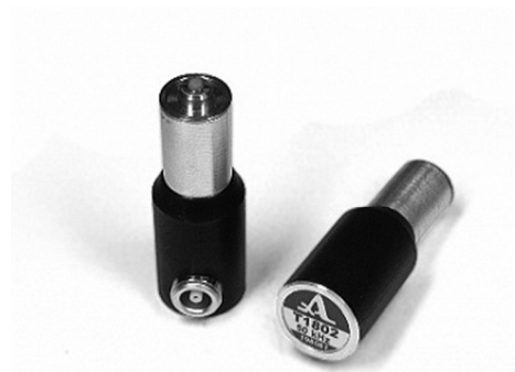
Рис. 2. Внешний вид ультразвуковых преобразователей для возбуждения и приема поперечных волн ( http://www.acsys.ru/production/detail/s1802/ )
