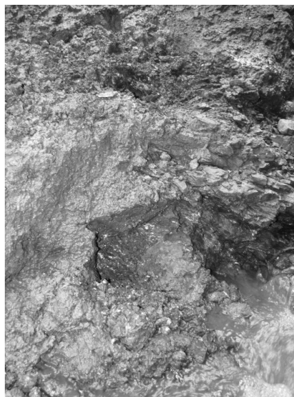
Рис. 2, б. Выветрелые до дресвяных глин аргиллиты
