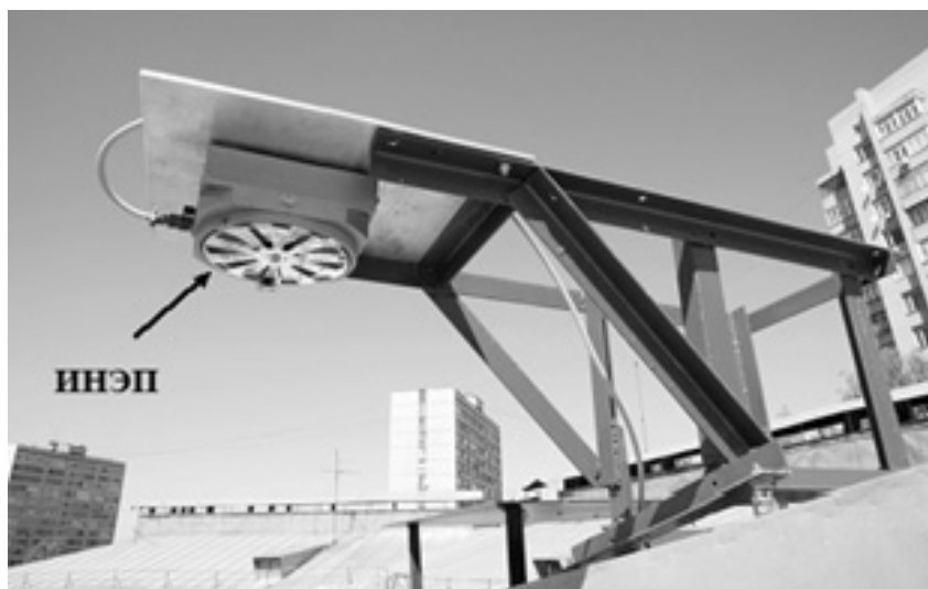
Рис. 3. Расположение флюксметра ИНЭП на установочной площадке
