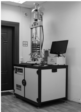
Рис. 2. Сервогидравлическая стабилометрическая установка Wille GeoTechnik 13-HG/020:001 (Германия)
