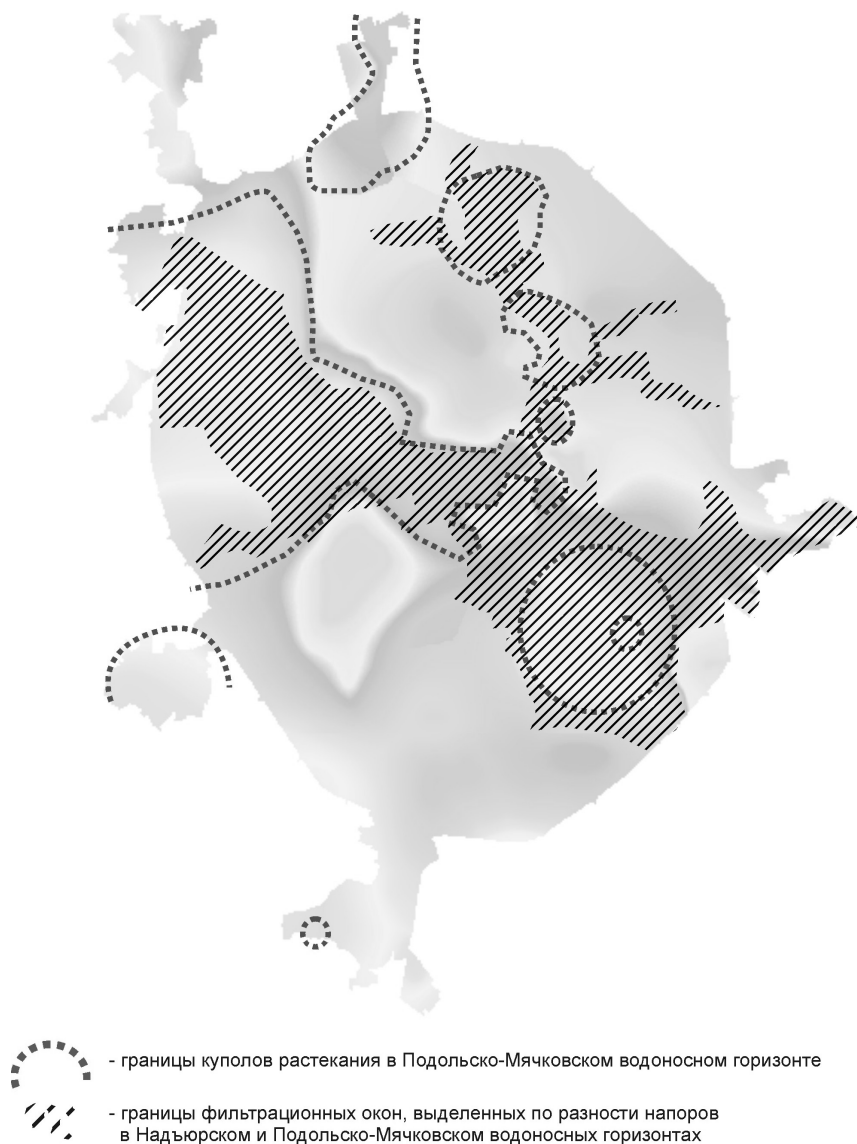
Рис. 1. Напоры подземных вод в Подольско-Мячковском водоносном горизонте с указанием фильтрационных окон, выделенных по гидродинамическим критериям
