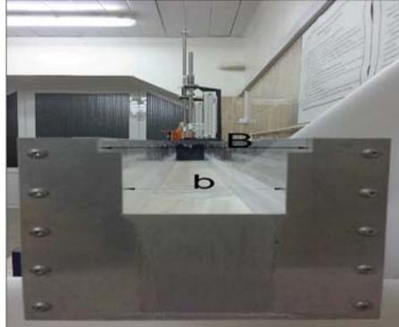
Рис.2. Фото водослива с указанием размеров.
