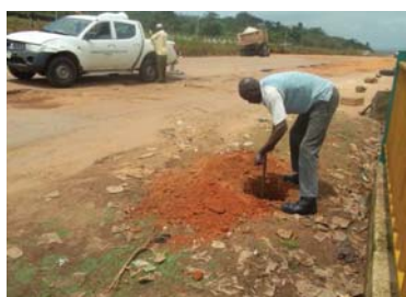
Рис 4 и 5. Железистый латерит для покрытия дорог содержит до 30% оксидов железа
