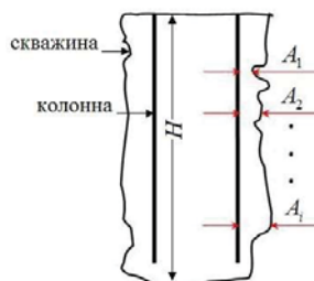
Рис. 3. Каверны стенки скважины
