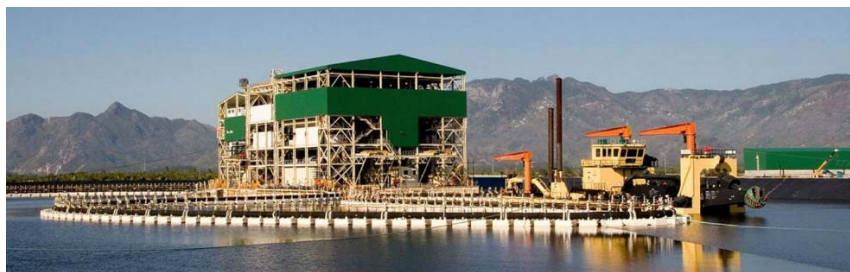
Рис. 8. Землесосная станция с рыхлителем для добычи рудных песков на месторождении Мадена
