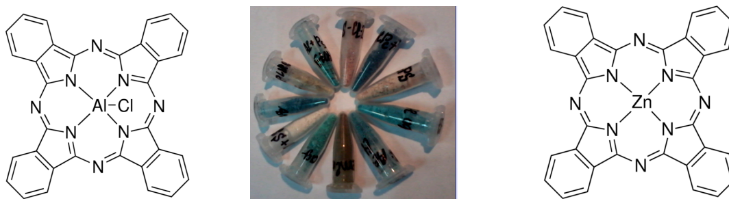
Рисунок 1. Структурные формулы металлокомплексов ZnPc (а) и AlClPc (б); образцы порошков нанопигментов, полученных на их основе (в).
