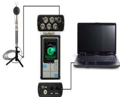
Рис. 3 Схема виброакустических измерений
