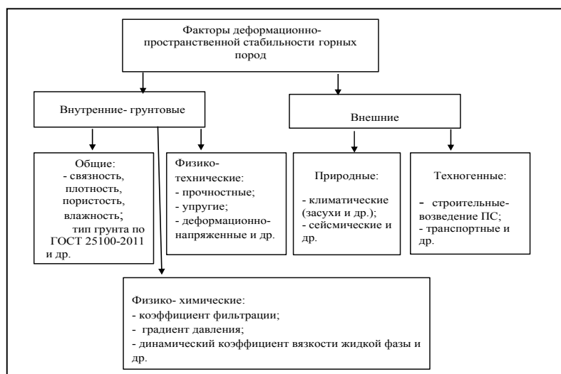
Рис. 2. Классификация факторов деформационно-пространственной устойчивости грунтов
