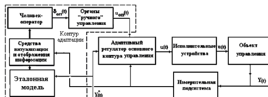
Рис. 6. Блок–схема динамической адаптивной человеко–машинной системы управления с человеком–оператором в контуре адаптации .
