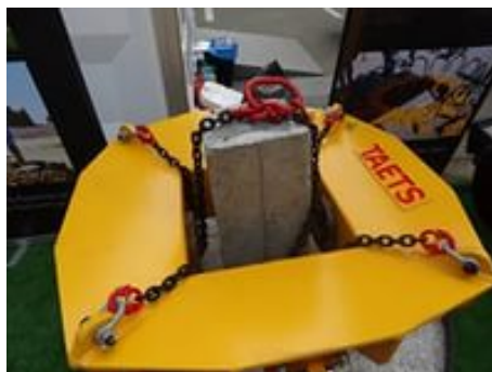
Рис.2 Устройство для срубки голов свай TAETS 4.4 .
