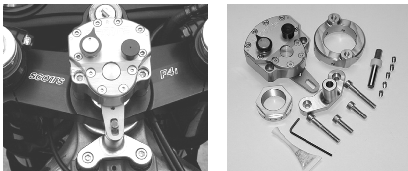
Рис. 1. Пример демпфера с ручной регулировкой упругости руля мотоцикла
