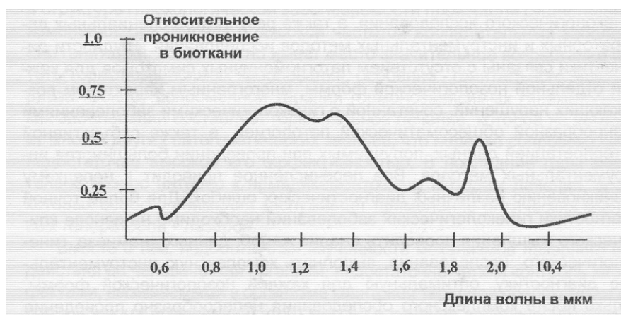
Рис. 3. Глубина относительного проникновения в биоткани в зависимости от длины световой волны
