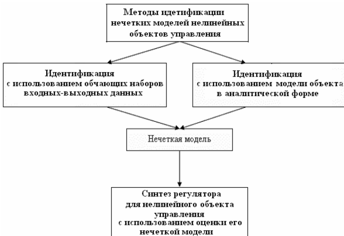
Рис. 5.3. Синтез регуляторов с использованием оценки нечеткой модели
