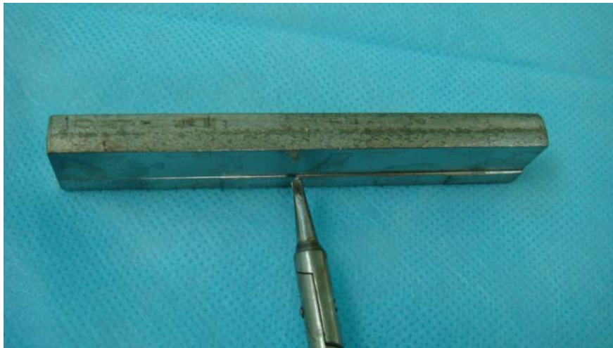
Рис. 2.3.8. Лекало с выступами от 0,1 до 0,6 мм и установка лезвия на необходимое выстояние
