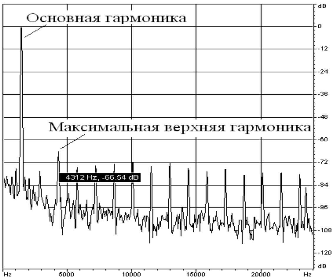
Рис.5.2. Спектр синусоидального сигнала 1000 Гц после аналого-цифрового преобразования
