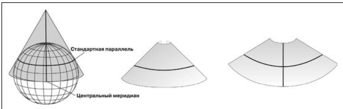
Рис. 5.1.7 Касательная коническая проекция
