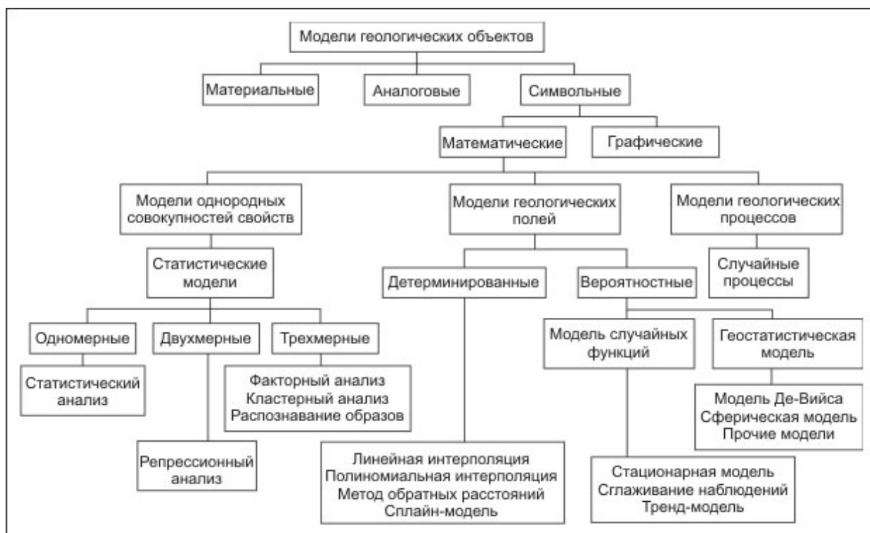
Рис.7.1 Схема классификации моделей геологических объектов
