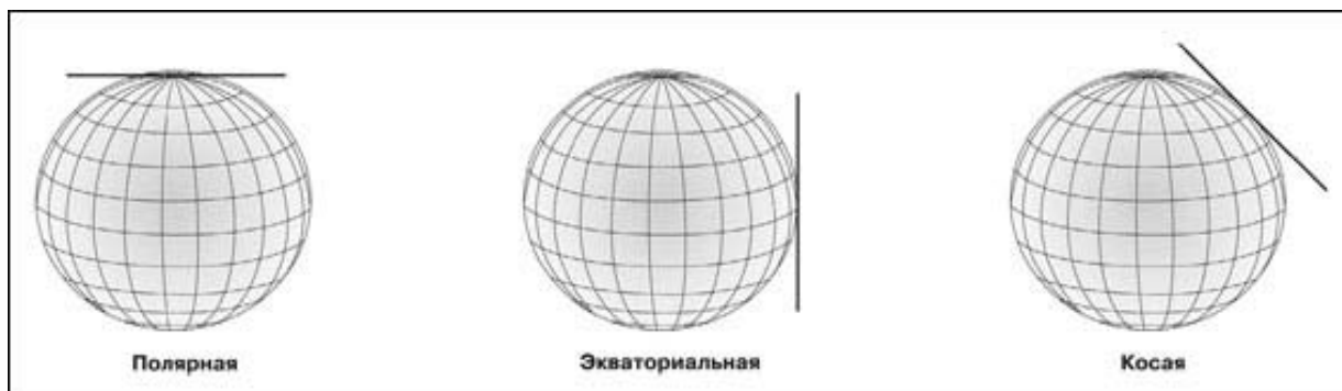
Рис. 5.1.10 Ориентировка азимутальных проекций
