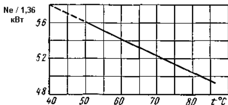
Рис. 15.3. Зависимость мощности N_e газового двигателя Д 2Г от температуры t газо-воздушной смеси в трубопроводе
