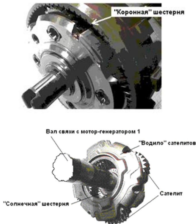
Рис. 11.6. Элементы конструкции устройства распределения мощности
