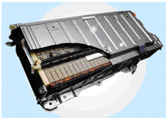
Рис. 5.1. Металл-никелевая гидридная батарея для гибридного автомобиля
