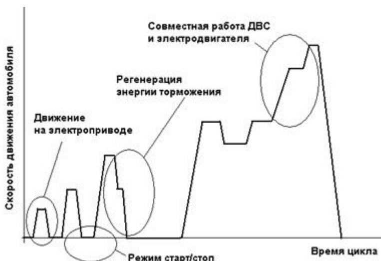
Рис. 4.2. Характерные зоны работы гибридной силовой установки
