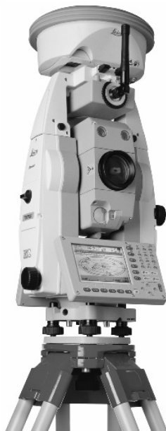
Рис. 28 . Электронный тахеометр с интегрированным GNSS-приемником Leica SmartStation
