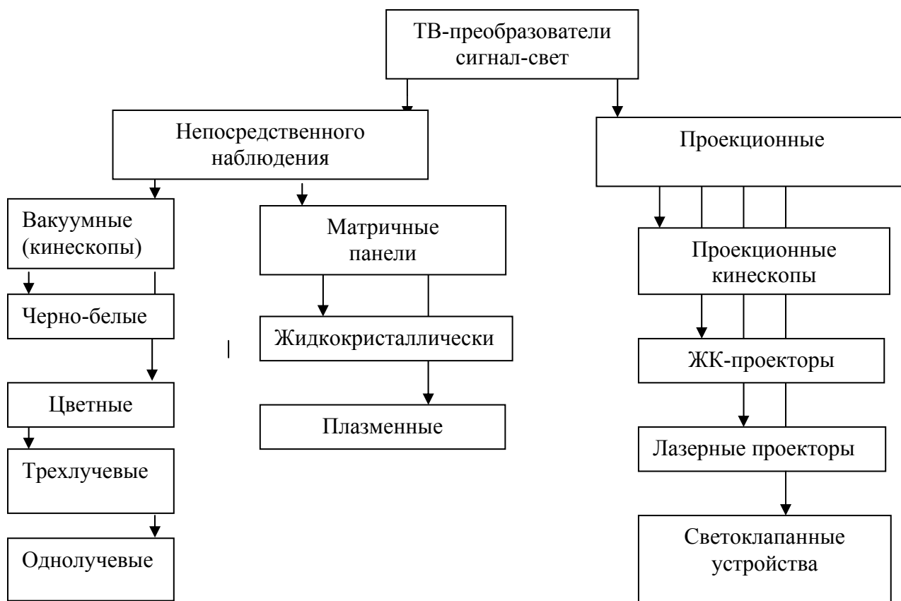
Рис. 12.1. Классификация ТВ-преобразователей сигнал-свет
