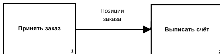
Рис. 3.2. Комбинированная стрелка выход–вход
