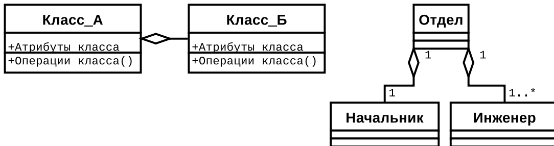
Рис. 8.12. Графическое изображение отношения агрегации на диаграмме классов в языке UML
