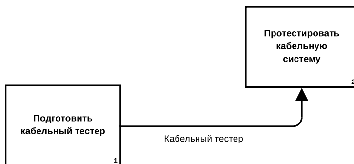
Рис. 3.4. Комбинированная стрелка выход–механизм исполнения
