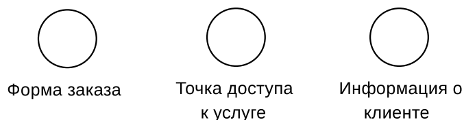
Рис. 8.3. Графическое изображение интерфейса в языке UML
