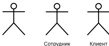
Рис. 8.1. Графическое изображение актёра в языке UML
