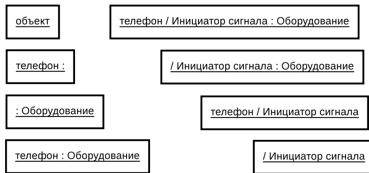
Рис. 8.26. Варианты возможных записей полного имени объекта в языке UML
