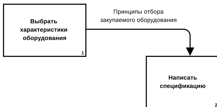
Рис. 3.3. Комбинированная стрелка выход–управление
