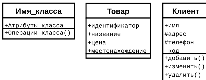
Рис. 8.10. Графическое изображение класса в языке UML
