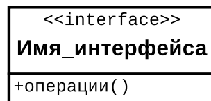
Рис. 8.16. Графическое изображение интерфейса на диаграмме классов в языке UML
