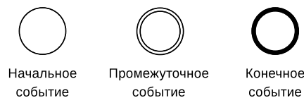
Рис. 9.3. Графическое изображение начального, промежуточного и конечного событий в нотации BPMN
