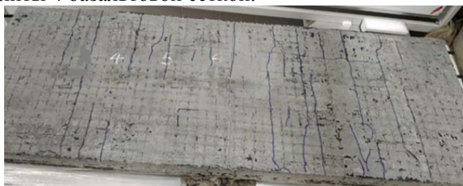
Рисунок 22 – Результаты трещин плита 4-го типа
