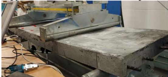
Рисунок 20 - Прогиб под нагрузкой плита типа 3
