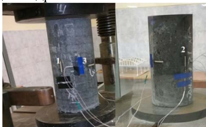
Рисунок 1 - Расположение тензометрических датчиков на цилиндрической керамзитобетонной колонне
