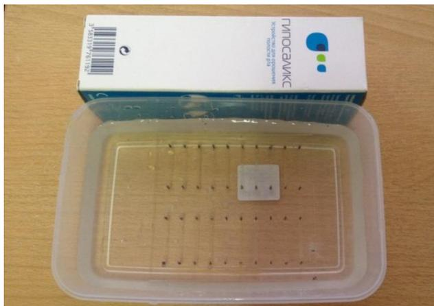
Рис. 2. Пластиковый контейнер с искусственной слюной и акриловой пластиной с образцами.
