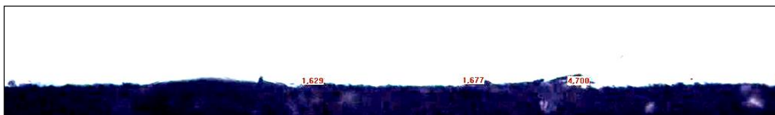
Рис. 2. Микрошлиф. Новая пластина, изнутри (1.6-2.7 мкм).
