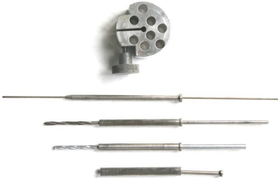
Рисунок 4. Внешний вид направляющего устройства (корпус направителя; втулка под спицу с расположенной в ней спицей; втулки под сверла 4,5 и 6 мм с расположенными в них сверлами; втулка под винт с расположенным в ней винтом)
