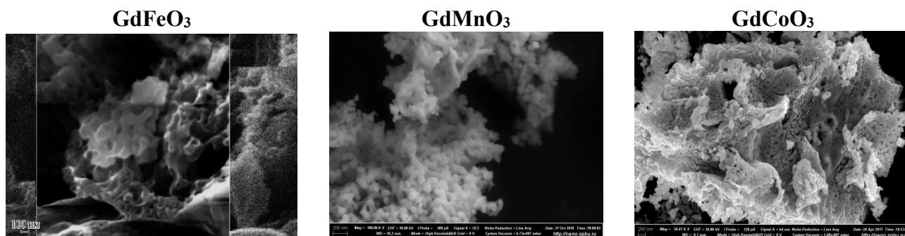
Рисунок 3. Микрофотографии сложных оксидов GdVO_3 ( V = Fe, Mn, Co ), синтезированных золь-гель технологией
