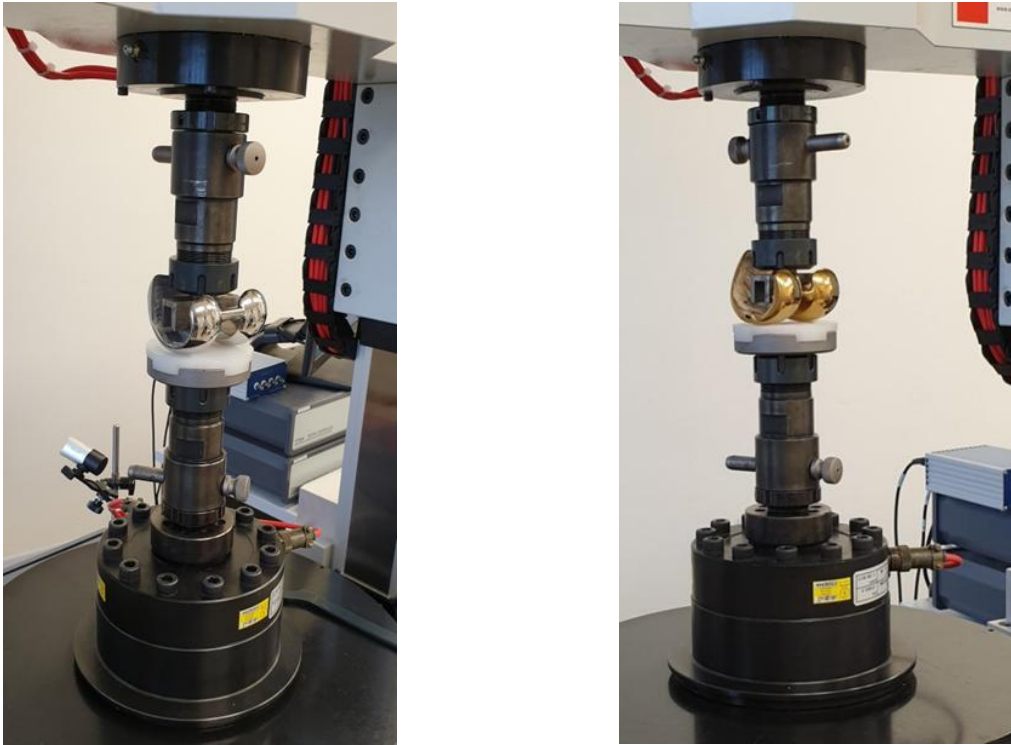
Рисунок 3 – Образцы в рабочей ячейке испытательной машины: а) CoCrMo; б) с TiN-покрытием.
