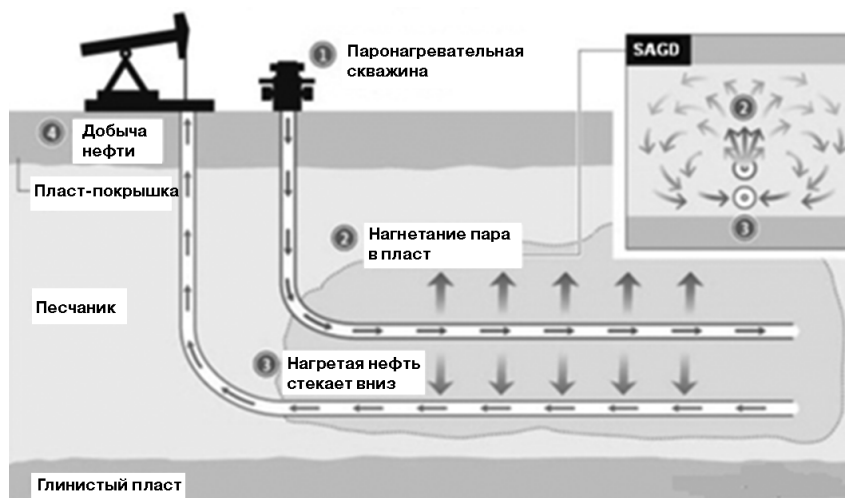
Рис. 3. Схема парогравитационного дренажа (SAGD)
