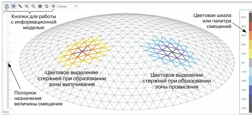
Рис. 7. Общий вид заданных зон искажения геометрической формы односетчатого купола
