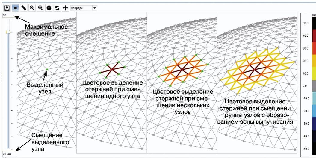
**Рис. 6.** Последовательность действий задания начальных несовершенств
