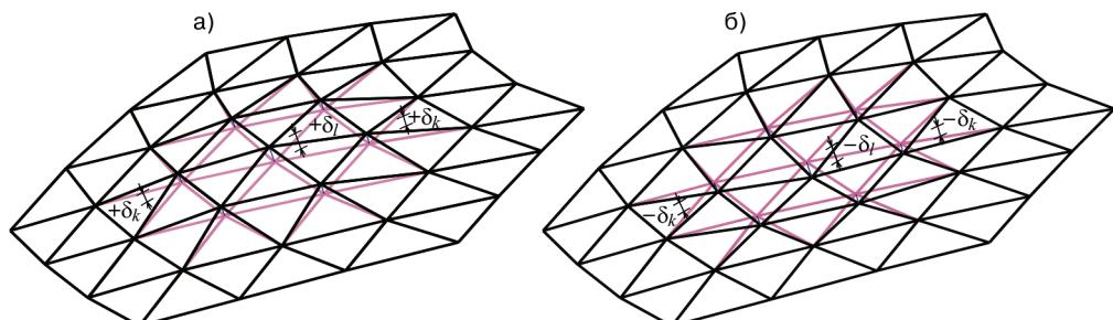
**Рис. 2.** Два варианта смещения группы узлов по нормали к поверхности купола:
