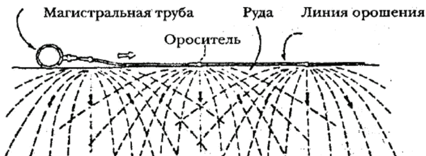
Рис. 2. Схема орошения штабеля при кучном выщелачивании [1]
