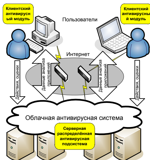
Рис. 5. Схема работы распределённых антивирусных систем
