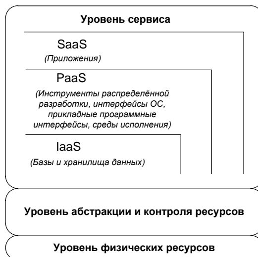
Рис. 1. Схема развёртывания и взаимосвязь облачных вычислительных сервисов
