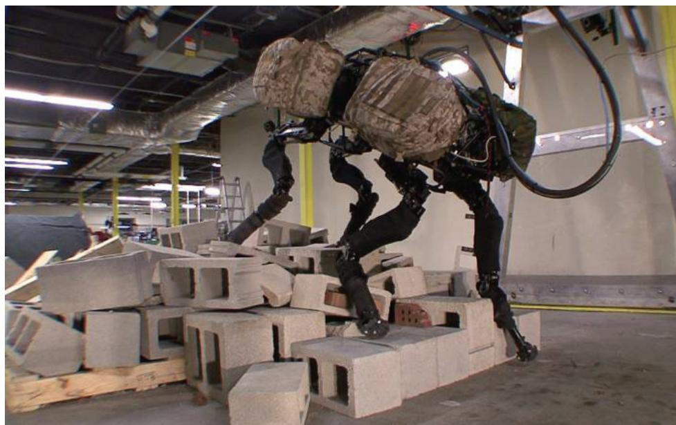
**Рис. 4.** Преодоление роботом BigDog неизвестных ему препятствий
