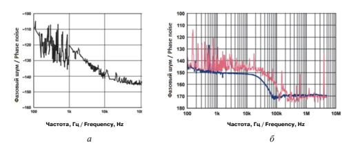
**Рис. 3.** Диапазон частот фазового шума выходного сигнала: a – микросхемы AD9834;  $\delta$  – микросхемы AD9102 **Figure 3.** The frequency range of the phase noise of the output signal: a – AD9834 chips;  $\delta$  – AD9102 chips
