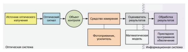
Рис. 1. Структурная схема автоматизированной системы оптических измерений
