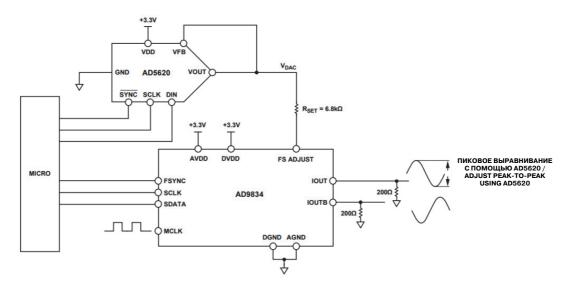
**Рис. 2.** Электрическая схема формирования синусоидального напряжения, построенная на микросхеме AD9834 **Figure 2.** Electrical circuit for the formation of a sinusoidal voltage based on the AD9834 chip
