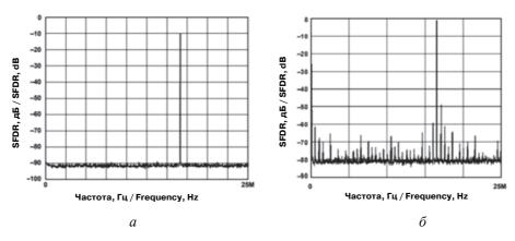
**Рис. 4.** Спектр выходного сигнала: a – микросхемы AD9834;  $\delta$  – микросхемы AD9830 **Figure 4.** The spectrum of the output signal: a – AD9834 chips;  $\delta$  – AD9830 chips
