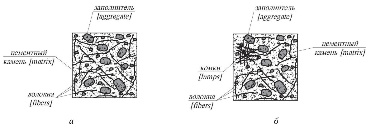
Схема дисперсно-армированного бетона:
