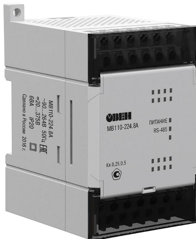
Рисунок 2 – Модуль аналогово ввода с универсальными входами MB110-8A
