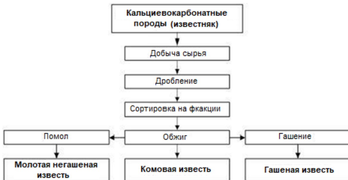
Рисунок 1 – Схема технологии получения извести из известняка
