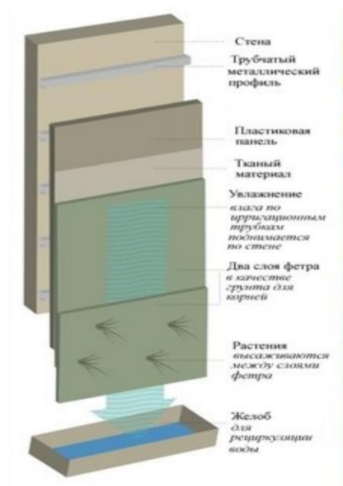
Рисунок 9 - Конструкция зелёного фасада [1]
