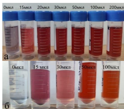
Рисунок 3 – Коллоидные растворы золота в деионизированной воде: свежие коллоидные растворы (а); растворы спустя 10 дней (б)
