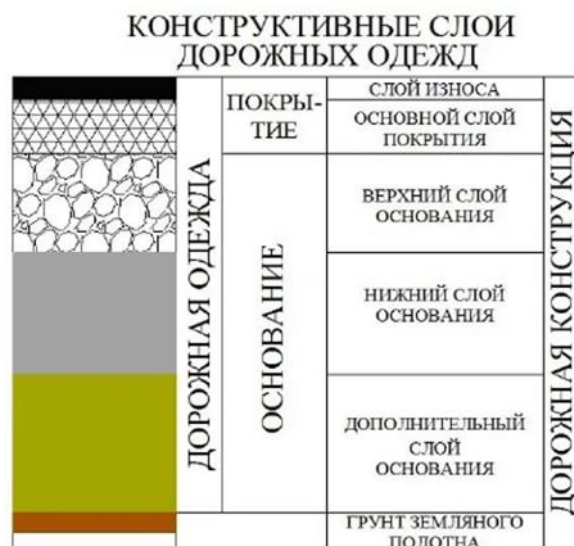
Рисунок 1 - Конструктивные слои дорожной одежды
