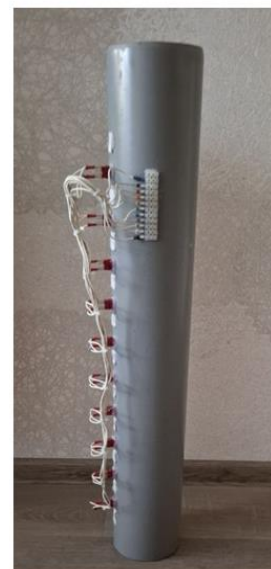
Рисунок 2 – Модуль для определения скорости движения оболочки: а) схема движения оболочки вдоль измерительного модуля; б) вид общий
