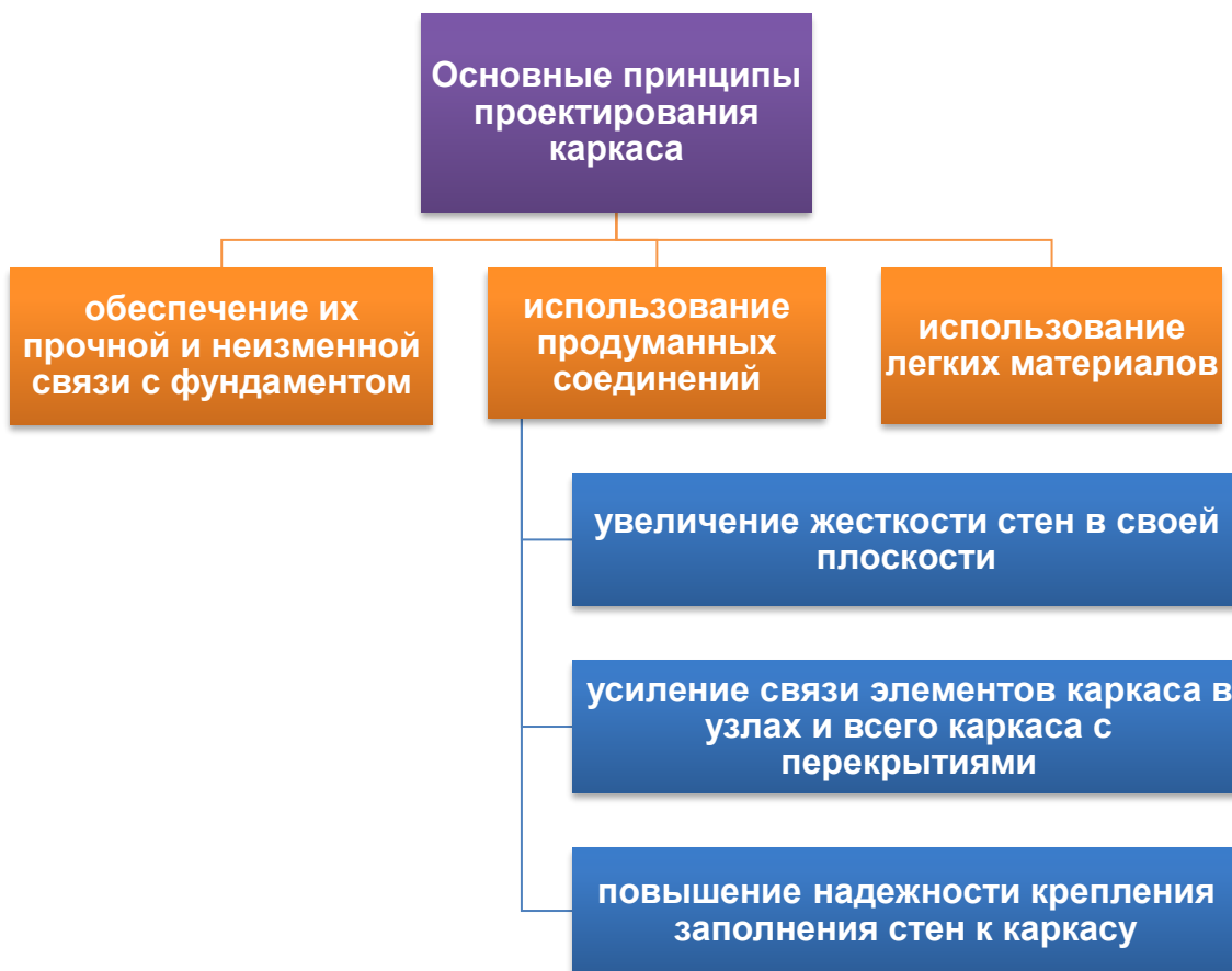
Рисунок 1 – Схема основных принципов проектирования деревянного каркаса
