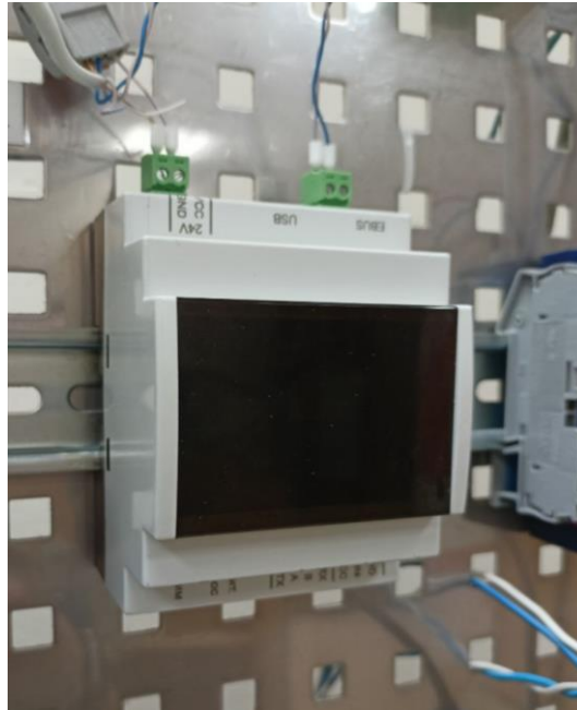
Рисунок 4 – Опытный образец контроллера ввода-вывода, установленный на DIN-рейку
