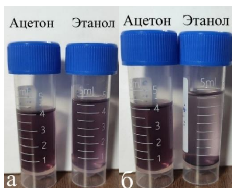
Рисунок 4 – Коллоидные растворы золота в ацетоне и этаноле: свежие коллоидные растворы (а); растворы спустя 10 дней (б)
