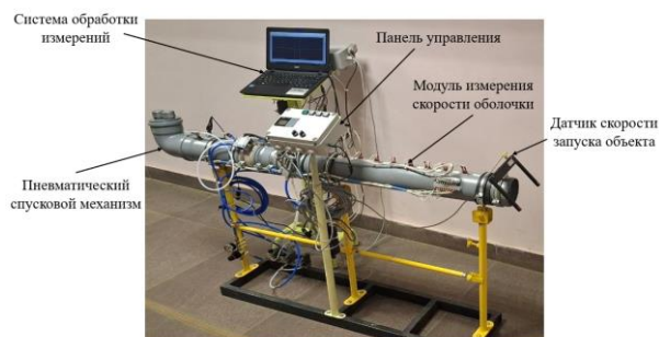
Рисунок 4 – Лабораторный стенд для исследования стартовых устройств с торообразным разгонным механизмом. Вид общий
