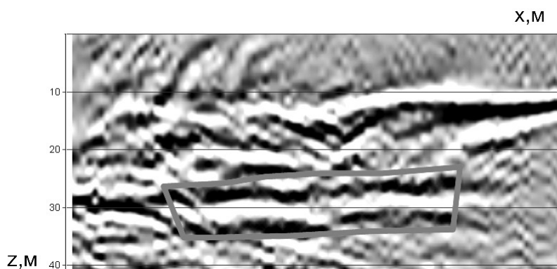
Рис. 2. Выделение фрагмента подземного туннеля метрополитена методом МОВ-ОГТ. Верхняя кромка сооружения находится на глубине 25 м
