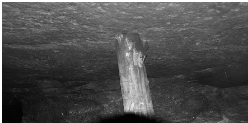
Рис. 2. Придавленный крепеж в шахте под микрорайоном Зелёная роща
