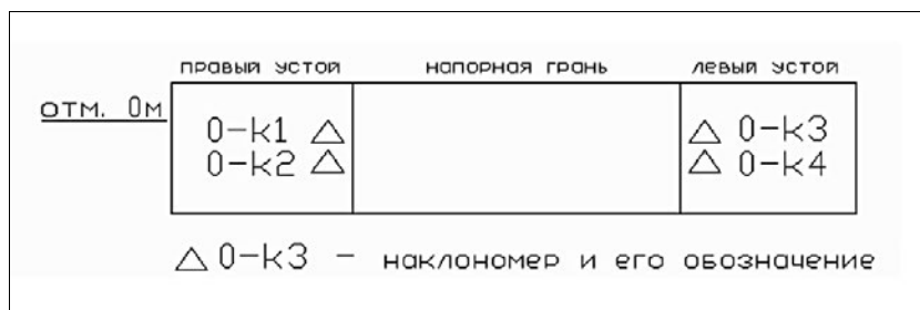
Рис. 1. Схема размещения наклономеров в здании водоприёмника на отметке 0 м
