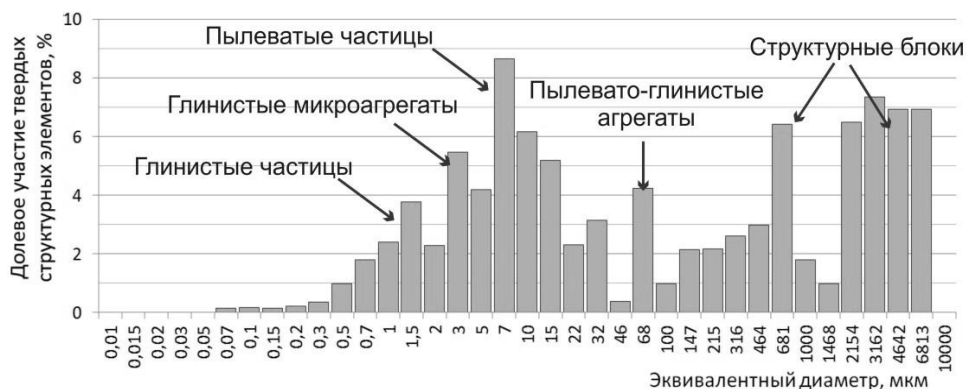
Рис. 3. Гистограмма распределения твердых структурных элементов по размеру образца суглинка тяжелого пылеватого (C 3 msc), рассчитанная с помощью ПО «СТИМАН» по РЭМ- и \mu КТ-изображениям
