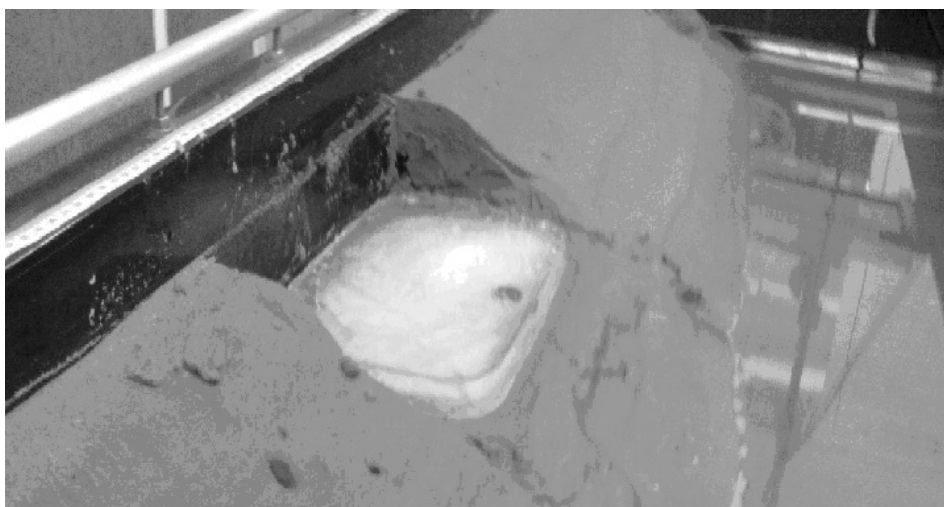
Рис. 2. Закладка ледяной пластины с пятном примеси в береговой откос при проведении лабораторного эксперимента
