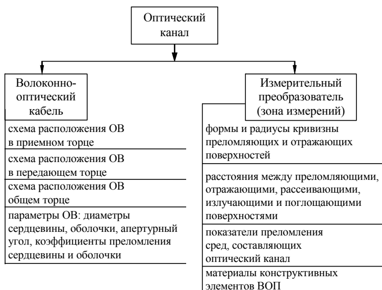
Рис. 6.8. Конструктивно-технологические параметры открытого оптического канала ВОДД
