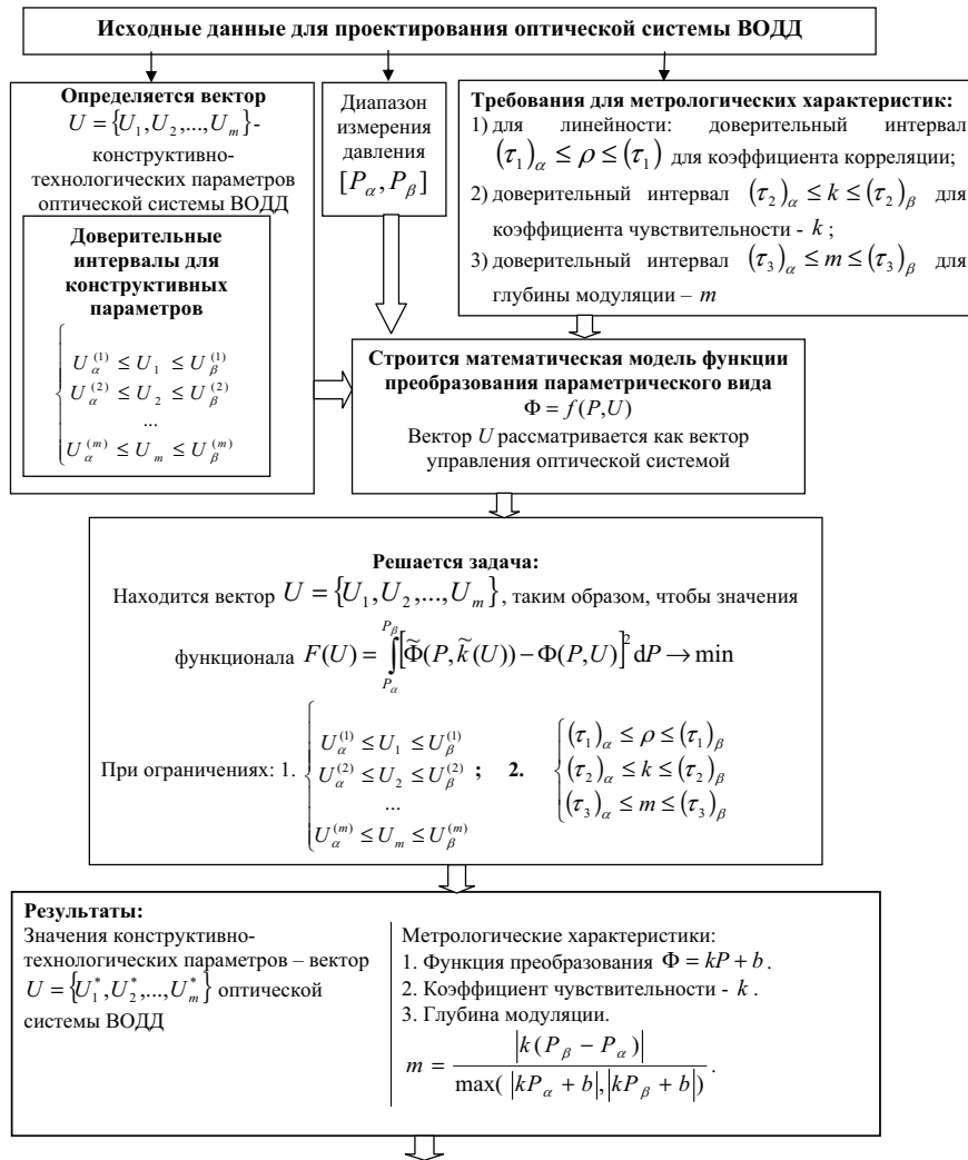
Рис. 6.9. Технологическая последовательность проектирования оптической системы ВОДД
