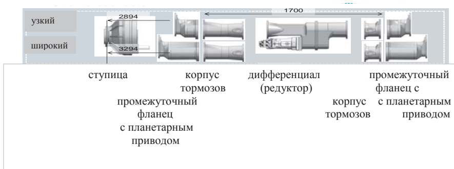
Рис. 1. «Принцип конструктора» компании NAF AG на примере управляемого мост
