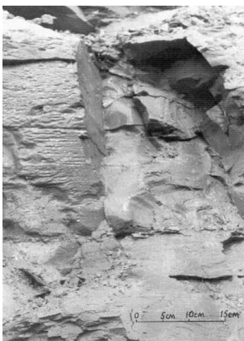
**Рис. 2. Синие глины как трещиновато-блочная среда (карьер «Красный Бор»)**
