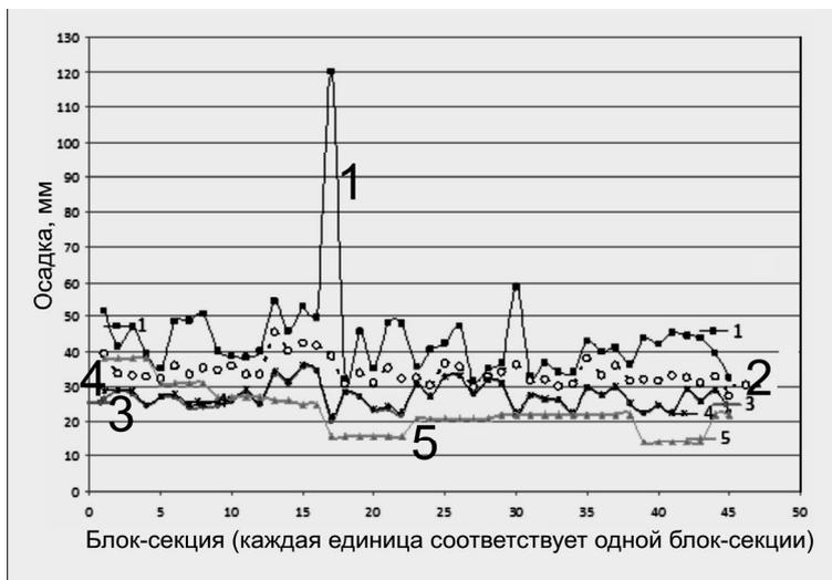
**Рис. 3. Осадки блок-секций, полученные по разным эффективным модулям общей деформации массива. Схема линейно-деформированного слоя**
