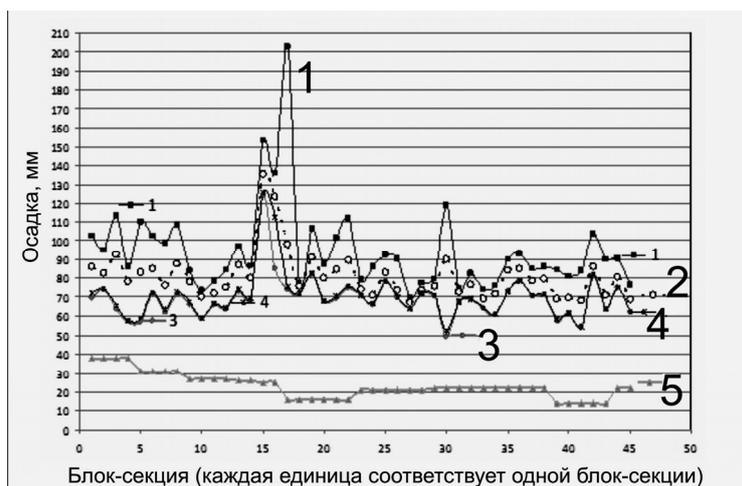
**Рис. 1. Осадки блок-секций, полученные по разным эффективным модулям общей деформации массива. Схема линейно-деформированного полупространства**
