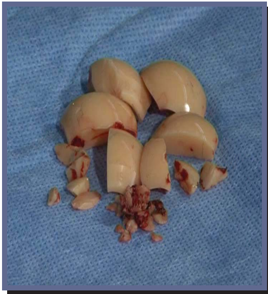
Рис. Перелом керамической головки эндопротеза (а – рентгенограмма тазобедренного сустава с переломанной головкой, б – фрагменты керамической головки извлеченные во время операции)
