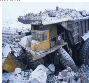
Рис. 1. Авария с карьерным самосвалом вследствие отказа тормозов
