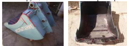
Рис.4. Повреждения и разрушения, наблюдаемые в ковше в условиях эксплуатации: красные линии – зоны повреждения
