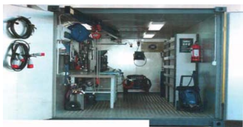
Фото - Ремонтный модуль фирмы AtlasCopco (расположение инструмента и приспособлений внутри модуля)
