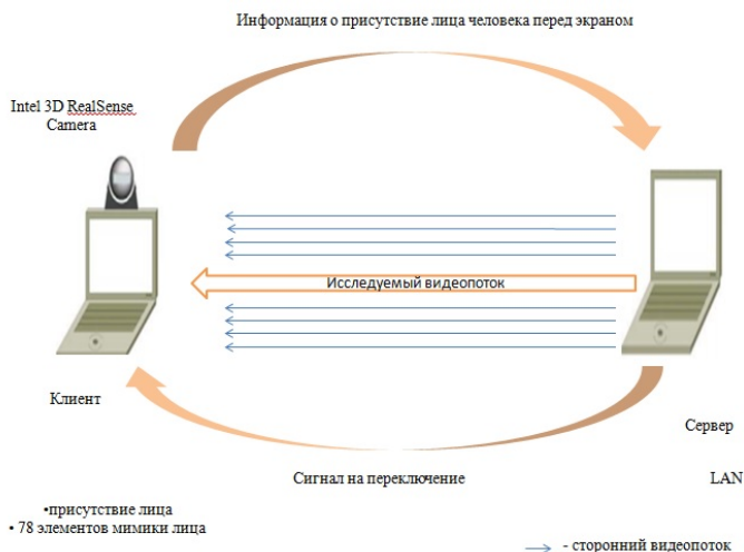
Рис. 3. Схема экспериментальной установки балансировки трафика, при наличии сторонней нагрузки в сети
