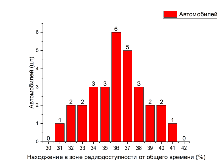
Рис. 5. Распределение времени радиодоступности наземных узлов при одном БПЛА
