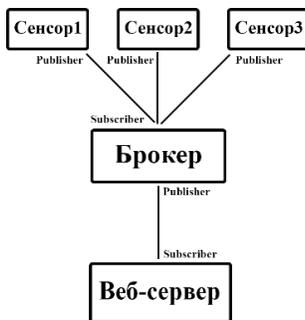
Рис. 1. Схема передачи информации о кластере на веб-сервер
