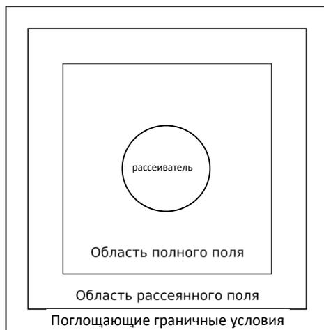
Рис. 1. Иллюстрация к методу полного и рассеянного поля
