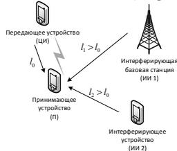
Рис. 1. Установление прямого соединения между D2D-устройствами
