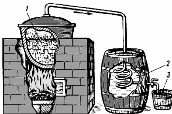
Рис. 6.6. Установка для производства этилового спирта: 1 – продукт брожения; 2 – вода; 3 – этиловый спирт
