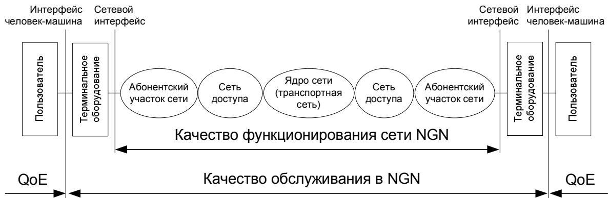
Рис. П.3. Общая эталонная конфигурация QoE, QoS и NP для сетей NGN
