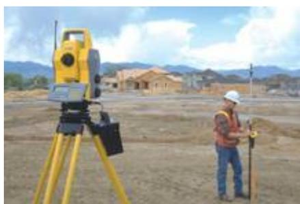
Безотражательная система с сервоприводами и возможностью автоматизированных Autolock и роботизированных Robotic измерений.
