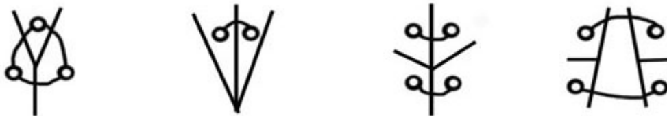
Рис. 5.2. Варианты границ, связывающих плоские поверхности
