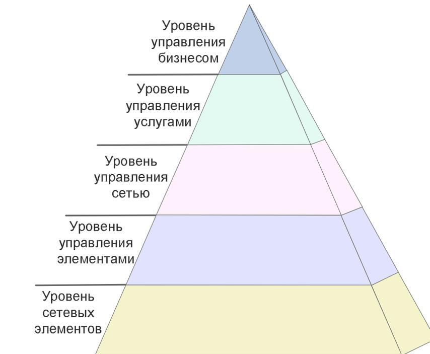
**Рис. 2.4. Логическая архитектура TMN**
