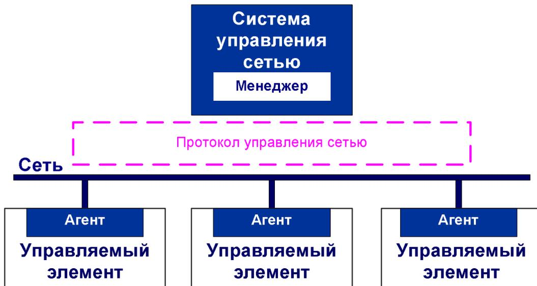
**Рис. 1.2. Архитектура управления сетью**
