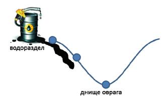
Рис. 12. Расположение площадок отбора проб относительно места разлива жидких загрязняющих веществ
