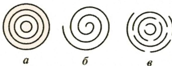
Рис. 3.11. Строение многослойных трубок: а – коаксиальная; б – спиральная; в – папье-маше
