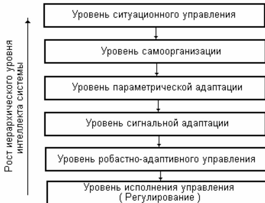
Рис. 12. Иерархическая структура интеллектуальной системы управления
